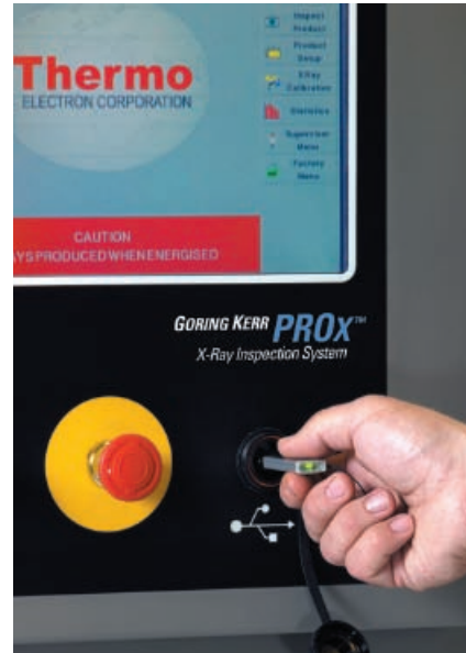
Overbrengen van gegevens naar een pc via de ingebouwde, waterdichte USB-aansluiting
